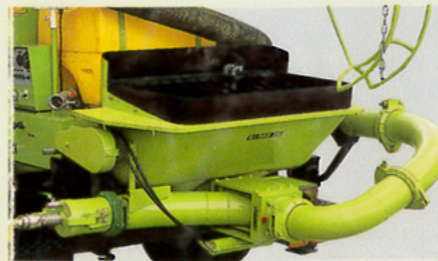
配管洗浄切替装置：配管洗浄状態
